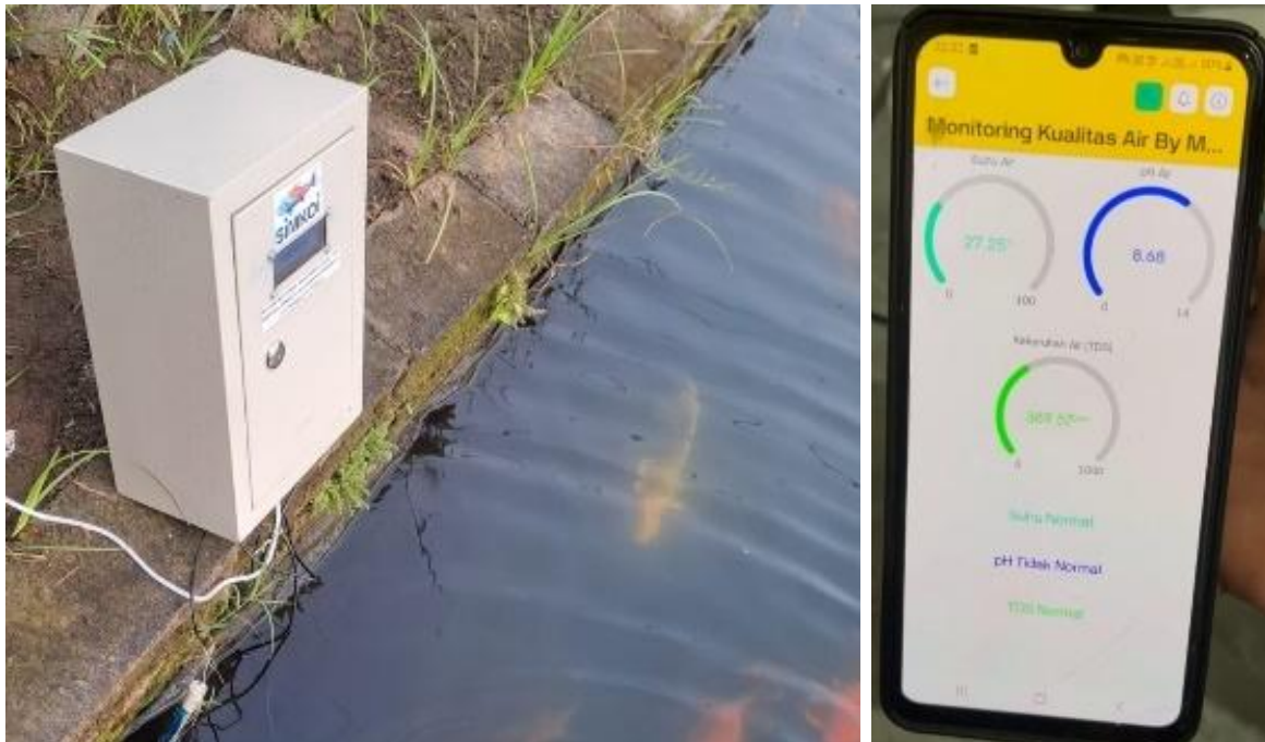
Gambar 6 Alat Fisik Monitoring Kualitas Air (kiri) dan Tampilan Monitoring di Smartphone via Blynk (kanan) Sumber : Dikembangkan oleh penulis, dokumentasi penulis (2025)
